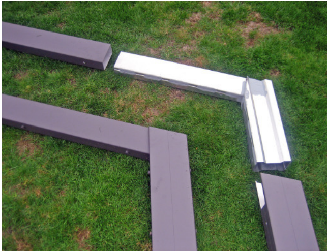
Bild 3 + 4: Montage der vorderen und hinteren Längsträger (Ausrichten)
