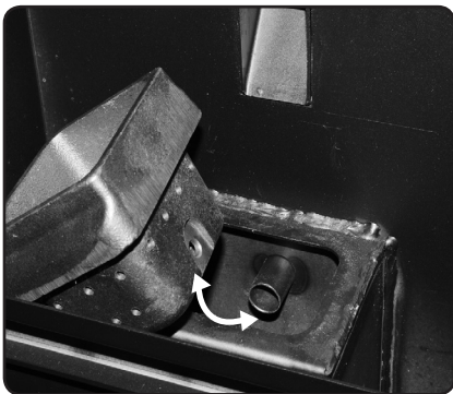
Abb. 8a: Brenntopf einsetzen
