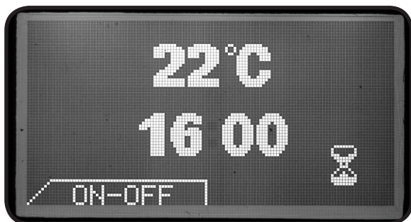
Abb. 9: Display-Anzeige während der Abkühlphase
