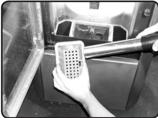
Abb. 14b: Reinigung der Luftöffnungen mit einem Staubsauger
