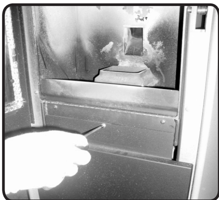
Abb. 15a: Öffnen der Frontplatte
