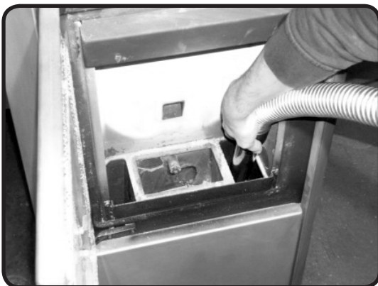
Abb. 14g: Reinigung untere Brennkammer
