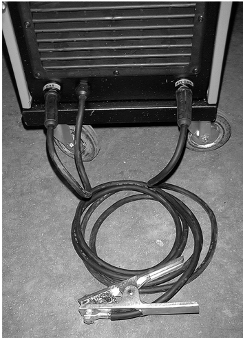
Priključak za režim u zaštitnoj atmosferi
