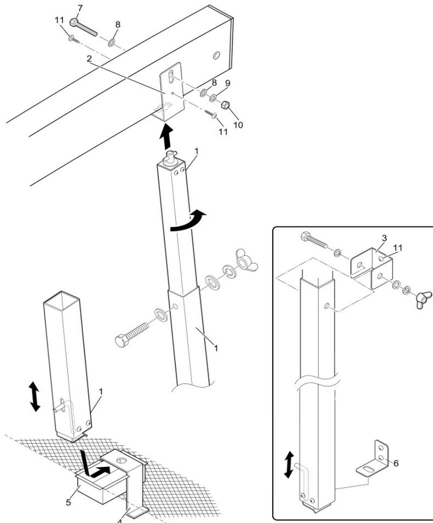
Befestigen Sie zunächst den oberen U – Bügel (2) an der – von vorne gesehen – zweiten mit Plastik abgedeckten Bohrung der Dachträger (Carport – Stückliste Pos. 2) mit Hilfe der Sechskantschraube mit Scheiben und Mutter (7; 8; 9; 10)
