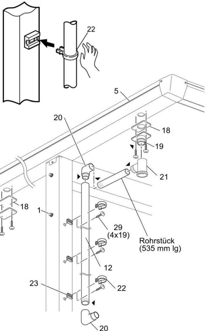
Das Regenrohr auf Länge sägen und am unteren Rohrende (12) ebenfalls Kleber auftragen und Ellbogen (20) einstecken. Rohr (12) mit Hilfe der Rohrhalter (22) am Bodenträger (1) befestigen.
