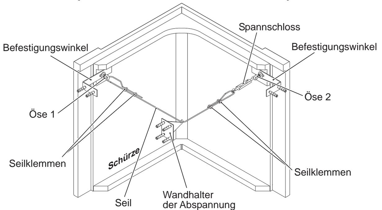
Führen Sie das eine Ende des Seils durch die Öse 1 und bilden mit den Seilklemmen eine Schlaufe. Das andere Seilende führen Sie durch die Öse des Spannschlusses und bilden nochmals mit zwei Seilklemmen eine Schlaufe. Das Spannschloss hängen Sie in die Öse 2 ein und lassen das Seil noch ungespannt locker hängen.
