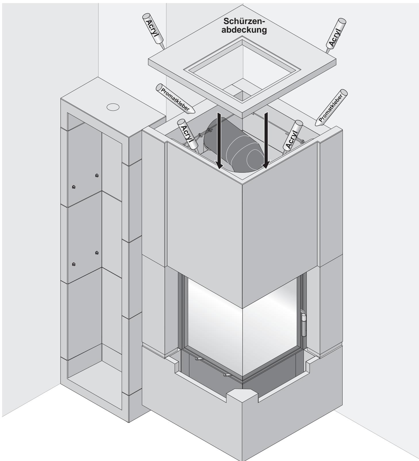
Verkleben Sie die Schürzenabdeckung mit Acrylkleber mit der oberen Schürzenabkantung und der Wand. Verkleben Sie die Schürzenabdeckung mit Promatkleber mit den Isolierplatten.
