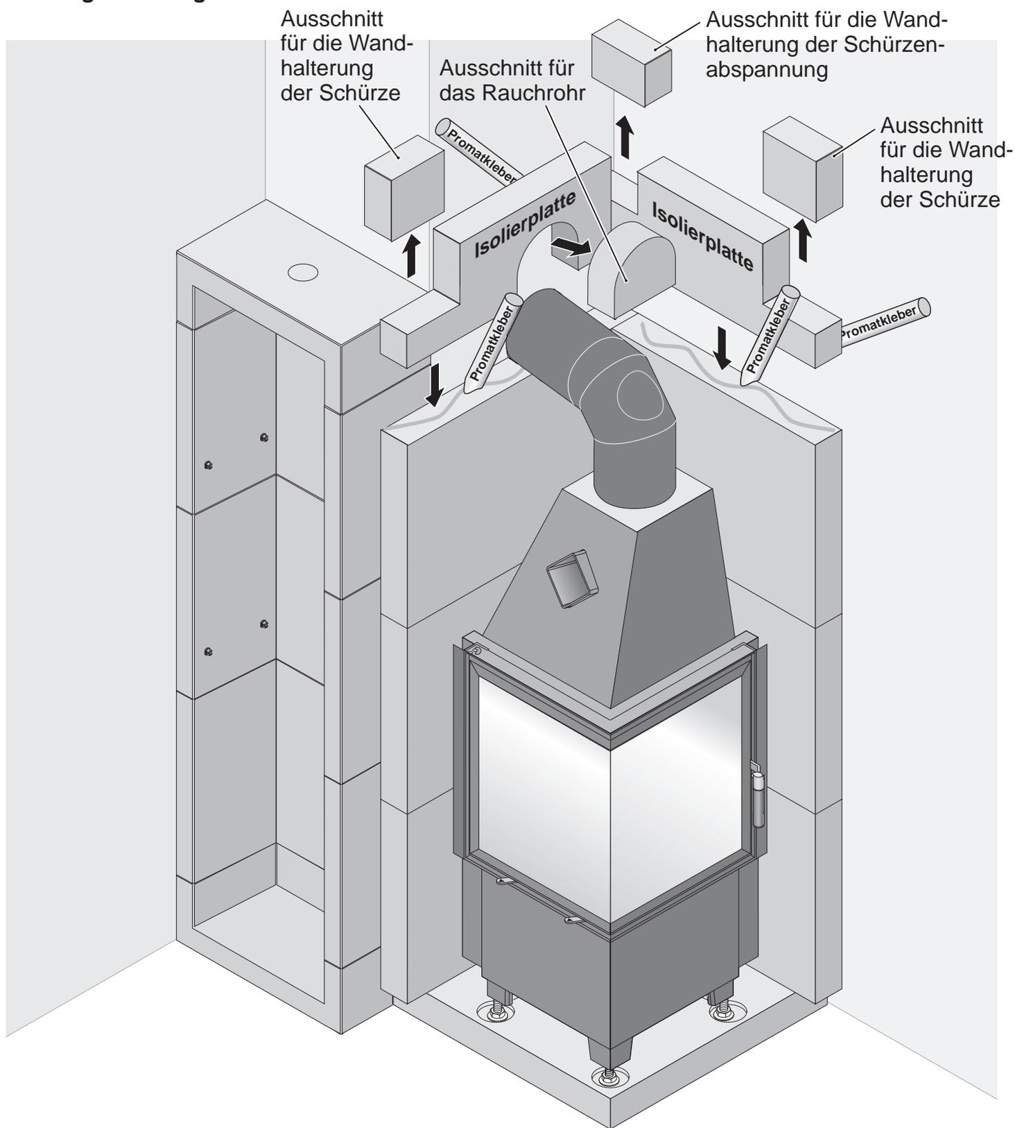
Versehen Sie die beiden Isolierplatten mit Ausschnitten, einmal für das Rauchrohr und für die Wandhalterungen der Schürzenabspannung sowie für die Wandhalterungen der Schürze. Verkleben Sie die Isolierplatten mit dem Promatkleber.
