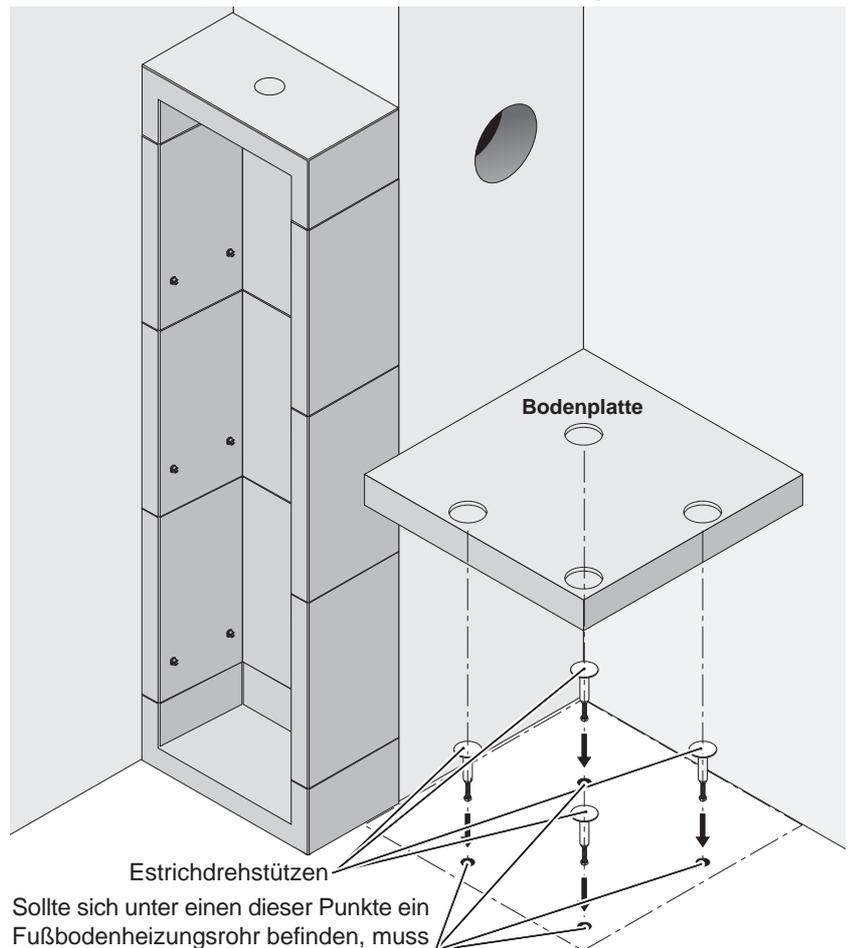
Sollte sich unter einen dieser Punkte ein Fußbodenheizungsrohr befinden, muss die Kernlochbohrung etwas versetzt werden, um eine Beschädigung des Fußbodenheizungsrohres zu vermeiden.
