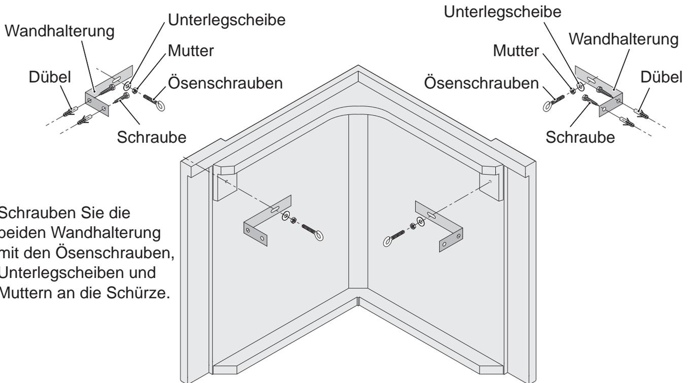
Schrauben Sie die beiden Wandhalterung mit den Ösenschrauben, Unterlegscheiben und Muttern an die Schürze.
