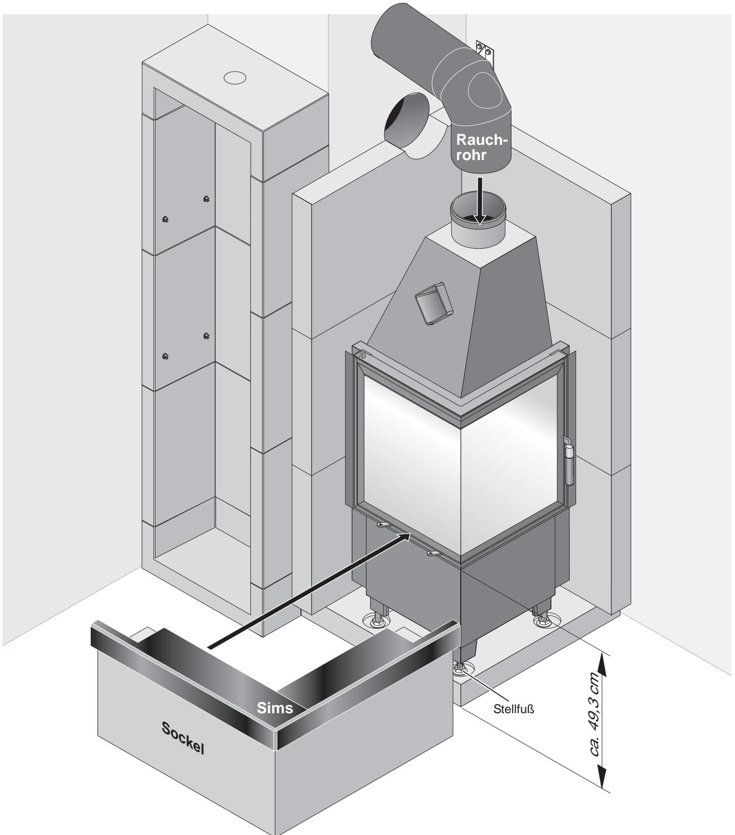
Stellen Sie die Radiante auf. Bringen Sie die Radiante (durch verstellen der Stellfüße) auf eine Höhe von Oberkante Fertigfußboden bis Unterkante Blendrahmen von 49,3 cm .
