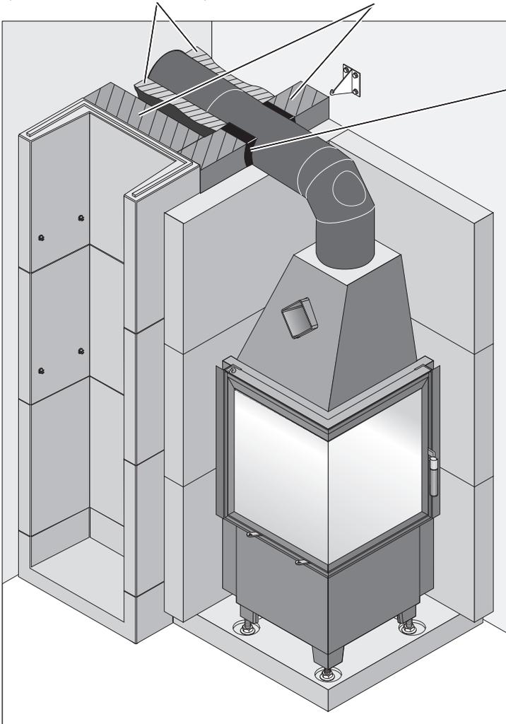
Der Rauchrohrdurchtritt im Bereich der Gasbetonsteine ist mit ca. 3 cm dicker Isolierwolle auszuführen.
