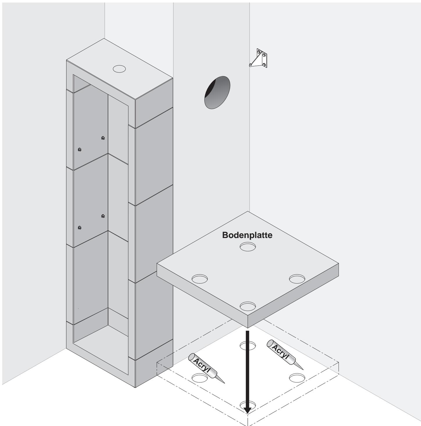
Kleben Sie die Bodenplatte punktuell mit Acrylkleber direkt in der Raumecke auf. Sollten Unebenheiten im Boden vorhanden sein, können Sie diese mit Fliesenkleber (nicht im Lieferumfang enthalten) ausgleichen.
