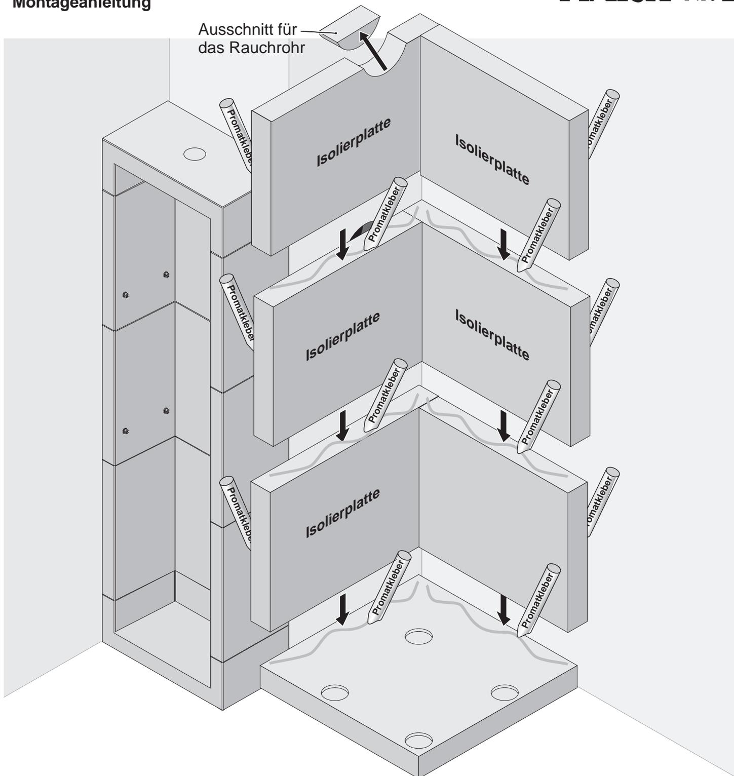
Vor dem Verkleben der Isolierplatten stellen Sie diese "trocken" auf und ermitteln die Rauchrohröffnung. Schneiden Sie die Rauchrohröffnung aus den Isolierplatten. Wischen oder Fegen Sie etwaigen Staub von den Klebeflächen der Isolierplatten. Tragen Sie punktuell den Promatkleber auf die Rückseiten der Isolierplatten auf und verkleben Sie diese mit der Wand und untereinander. Verkleben Sie die senkrechten und waagerechten Fugen der Isolierplatten untereinander mit einer durchgehenden Fuge.
