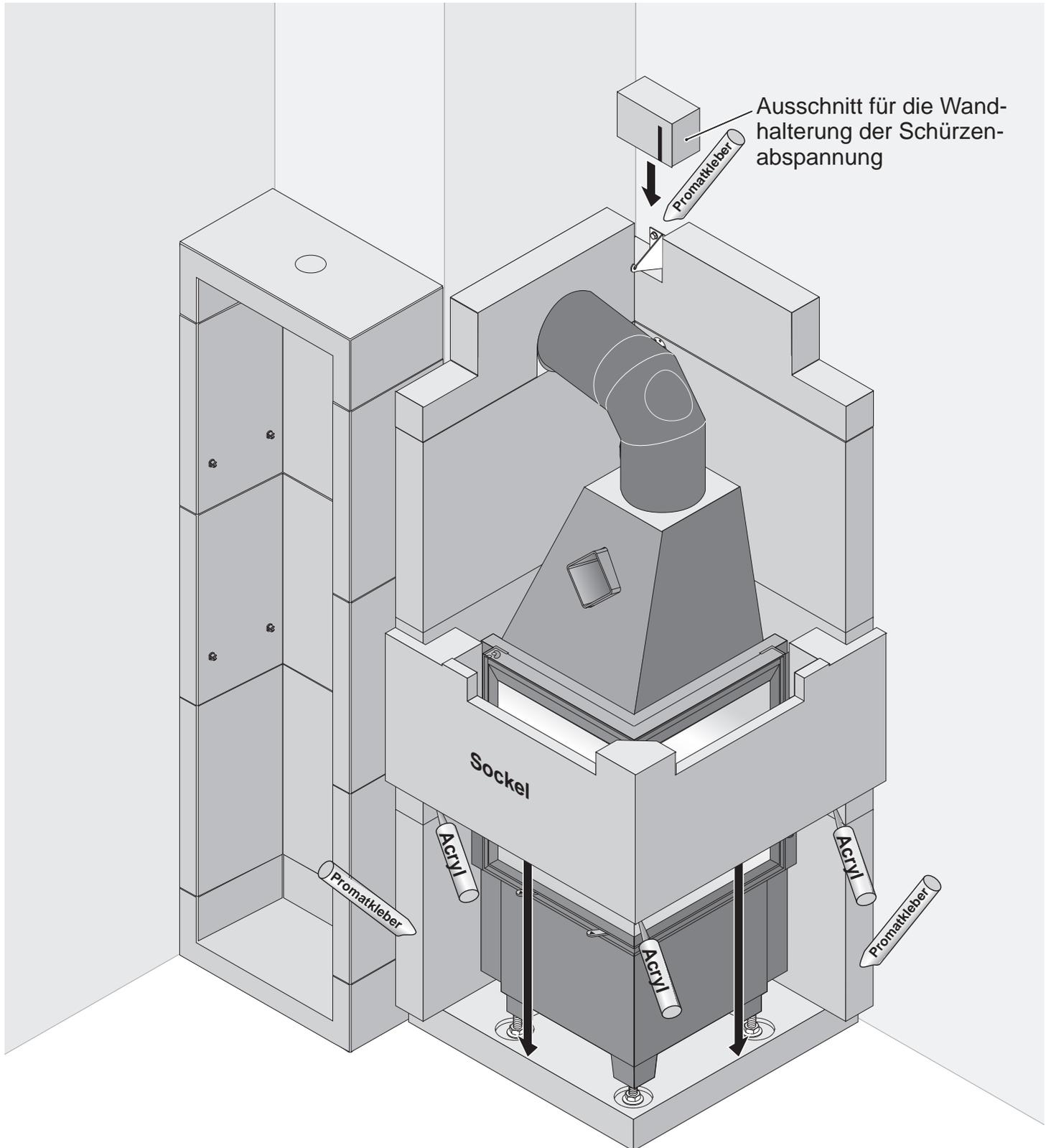
Kleben Sie den Sockel mit Acrylkleber auf die Bodenplatte und mit Promatkleber an die Stirnseiten der entsprechenden Isolierplatten.
