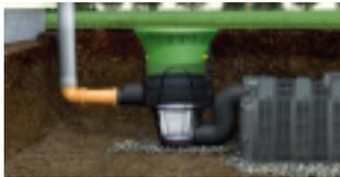
Drainstar-Filter Extern, begehbar für den Einbau vor einer Versickerungsanlage. Wirkungsgrad 100%, leichte Reinigung durch glatte Siebstruktur. Ohne Höhenverlust zwischen Zu- und Auslauf. Bei größeren versiegelten Flächen besteht die Möglichkeit mehrere Drainstar-Filter parallel zu schalten. Stufenlos von 600-1050 mm an gegebene Geländesituationen anpassbar durch Teleskopaufsatz, abgedichtet bis Erdoberfläche durch EPDM-Profilabdichtung
