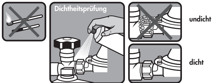
Abb. 2: Dichtheitsprüfung
