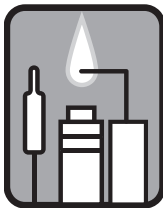
Abb. 4a: Wächterflamme brennt falsch
