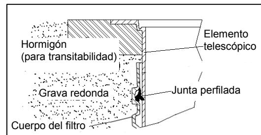
**Atención:** Si el jabón blando se seca la cubierta telescópica tiene poca movilidad y existe el riesgo de que la junta salga de la ranura. Antes de proceder al relleno hay que comprobar el asiento correcto de la junta. La cubierta telescópica tiene que estar suficientemente recalzada para evitar que las fuerzas se transmitan al cuerpo del filtro.
