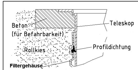
**Achtung:** Trocknet die Schmierseife an lässt sich das Teleskop nur noch sehr schwer bewegen und es besteht die Gefahr, dass die Dichtung aus der Dichtnut rutscht. Vor dem Verfüllen muss die Dichtung auf ihren korrekten Sitz überprüft werden. Das Teleskop muss ausreichend unterfüttert werden, so dass sich Kräfte auf keinen Fall auf das Gehäuse übertragen können.
