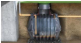
Carat Sedimentationstank zur Behandlung von Regenwasser entsprechend Merkblatt DWA-M 153. Aus dem Qualitätswerkstoff Duralen® (PP) gefertigt, zu 100% recycelbar. 8 Anschlussmöglichkeiten DN 100/150, davon 5 vorbereitet mit Lippendichtungen DN 100. Großer Einstiegsdom (360° drehbar) nach DIN 1989. Einstiegsöffnung Ø 800/650 mm, H = 610 mm. Abgedichtet bis Geländeoberkante in Verbindung mit Teleskop-Domschacht und Profildichtung. 25 Jahre Hersteller-Garantie
