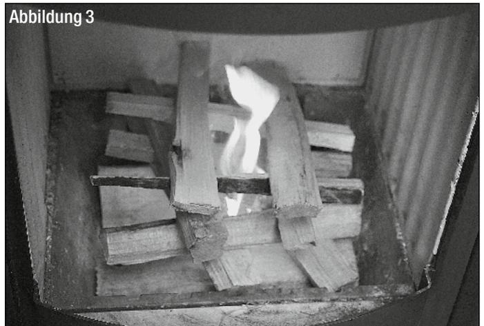
Lassen Sie diese Holzaufgabe mit geöffneten Verbrennungsluftreglern herunterbrennen, bis eine Grundglut vorhanden ist (Abb. 4).
