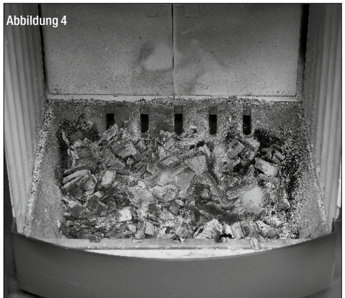
Je nach Holzgüte, Schornsteinzug und Witterung dauert diese Verbrennungsphase unterschiedlich lange. Legen Sie jetzt zwei weitere Holzstücke parallel zur Feuerraumscheibe auf und verschließen die Feuerraumtür (Abb. 5).
