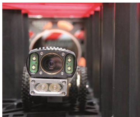
Inspection à l'aide d'une caméra téléguidée
