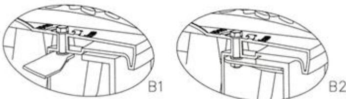
B1 Sicherungsriegel geöffnet
