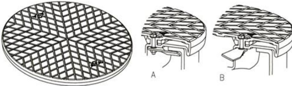
A Sicherungsriegel geschlossen
